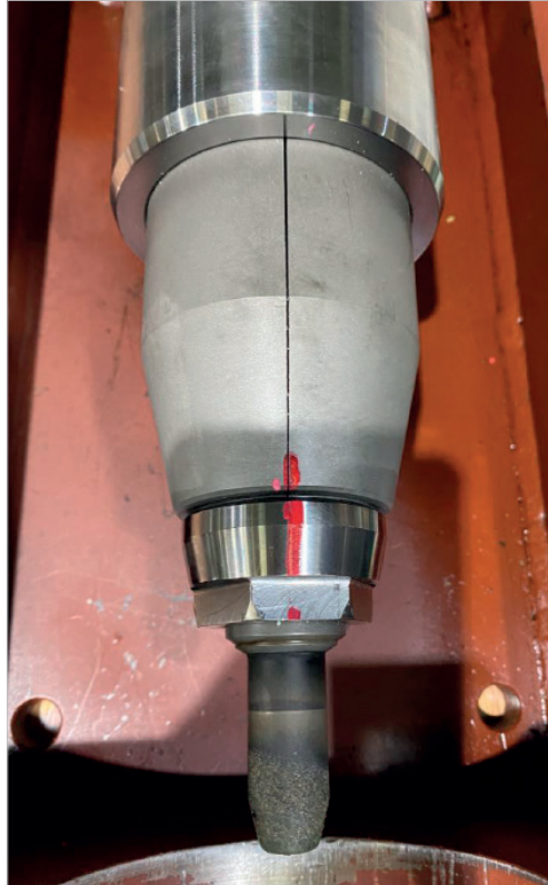
Fig. 34: FBIVS spindle guide failure
