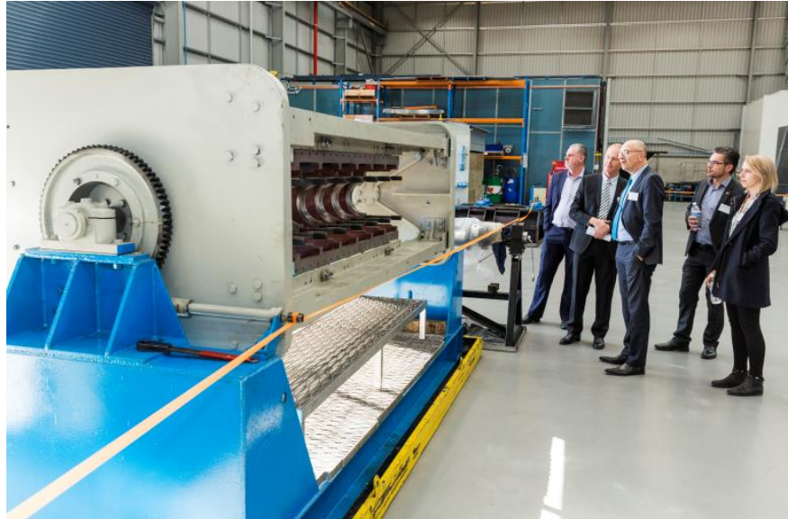
Die Besucher auf ihrem Rundgang – vor dem Motor einer XPT-Lokomotive (Express Passenger Train), die nach 30.000 Betriebsstunden gewartet wird
