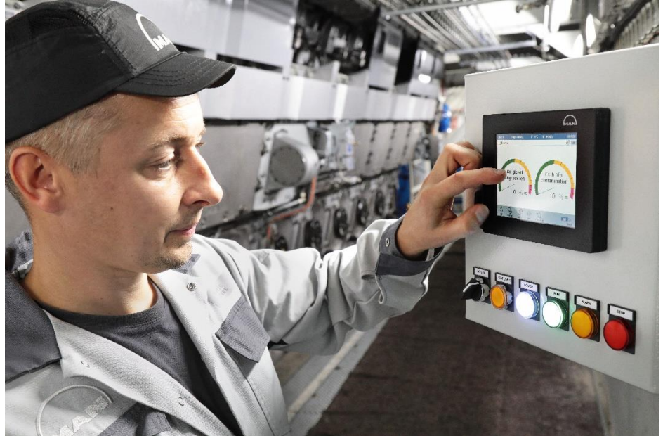
Der MAN Fluid Monitor stellt den Schutz der Motoren bei Prüfstandsversuchen im Werk von MAN in Saint-Nazaire sicher.
