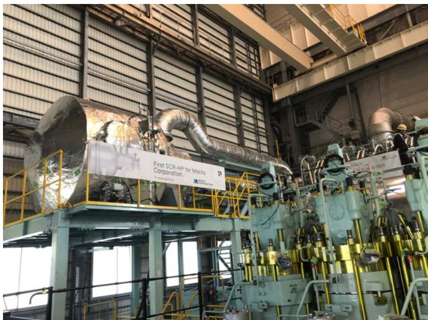
SCR-HP-System (Cluster 3), montiert auf dem Motor, beim Prüfstandtest
