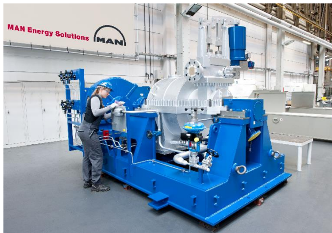
MAN Dampfturbine bei der Montage
