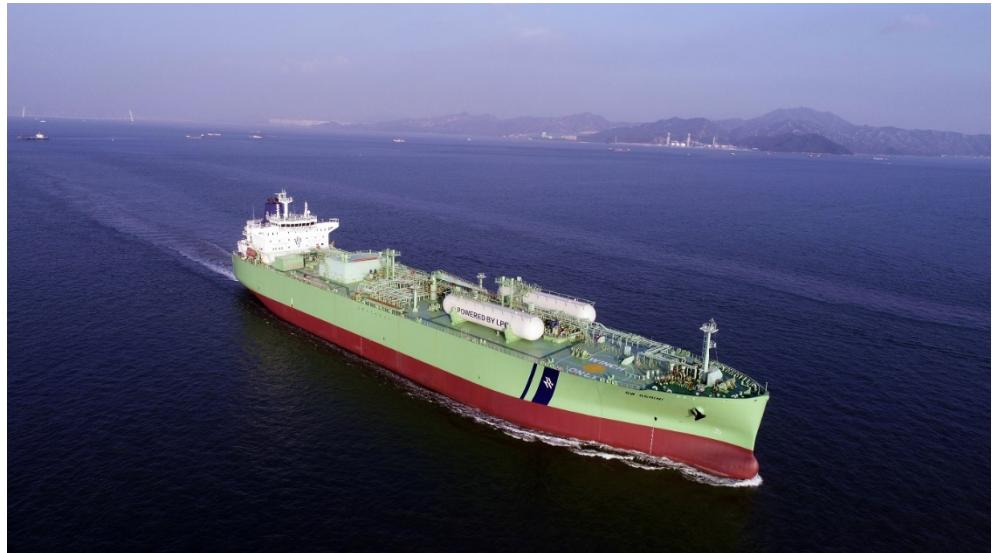
*Die „BW Gemini“, ein VLGC-Tanker aus der LPG-Flotte der BW, wurde von einem MAN B&W 6G60ME-C9.2-Hauptmotor auf einen MAN B&W Dual-Fuel-6G60ME-Motor nachgerüstet, der mit Brennöl und LPG betrieben werden kann. Die Nachrüstung ist die erste von zwölf Nachrüstungen von LPG-Tankern, die sich im Besitz von BW LPG befinden (Bild mit freundlicher Genehmigung von BW LPG)*
