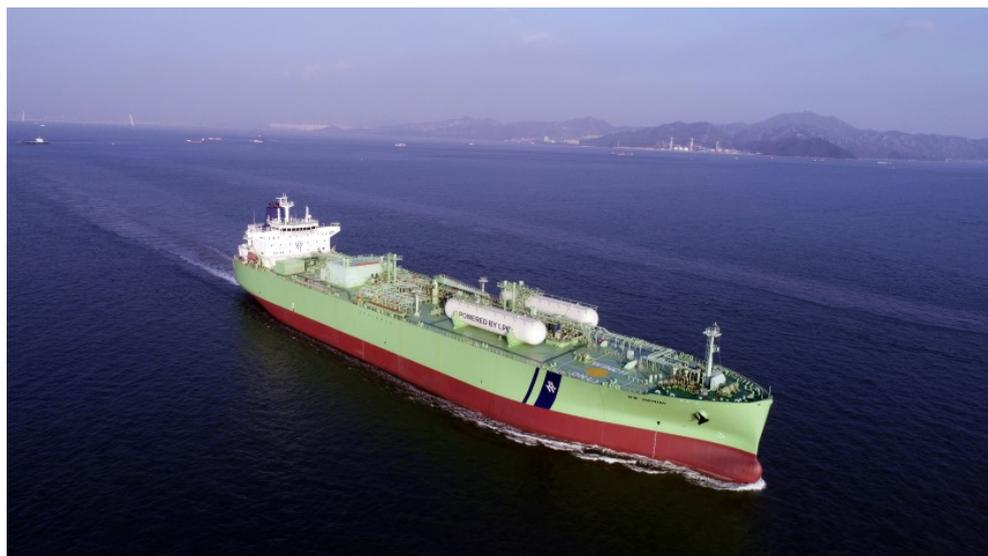
*Die „BW Gemini“, ein VLGC-Tanker aus der BW LPG-Flotte, wurde von einem MAN B&W 6G60ME-C9.2-Hauptmotor auf einen MAN B&W 6G60ME-C9.5.LGIP-Dual-Fuel-Motor nachgerüstet, der mit Brennöl und LPG betrieben werden kann. Die Nachrüstung ist die erste von 15 Nachrüstungen von LPG-Tankern, die sich im Besitz von BW LPG befinden (Bild mit freundlicher Genehmigung von BW LPG)*
