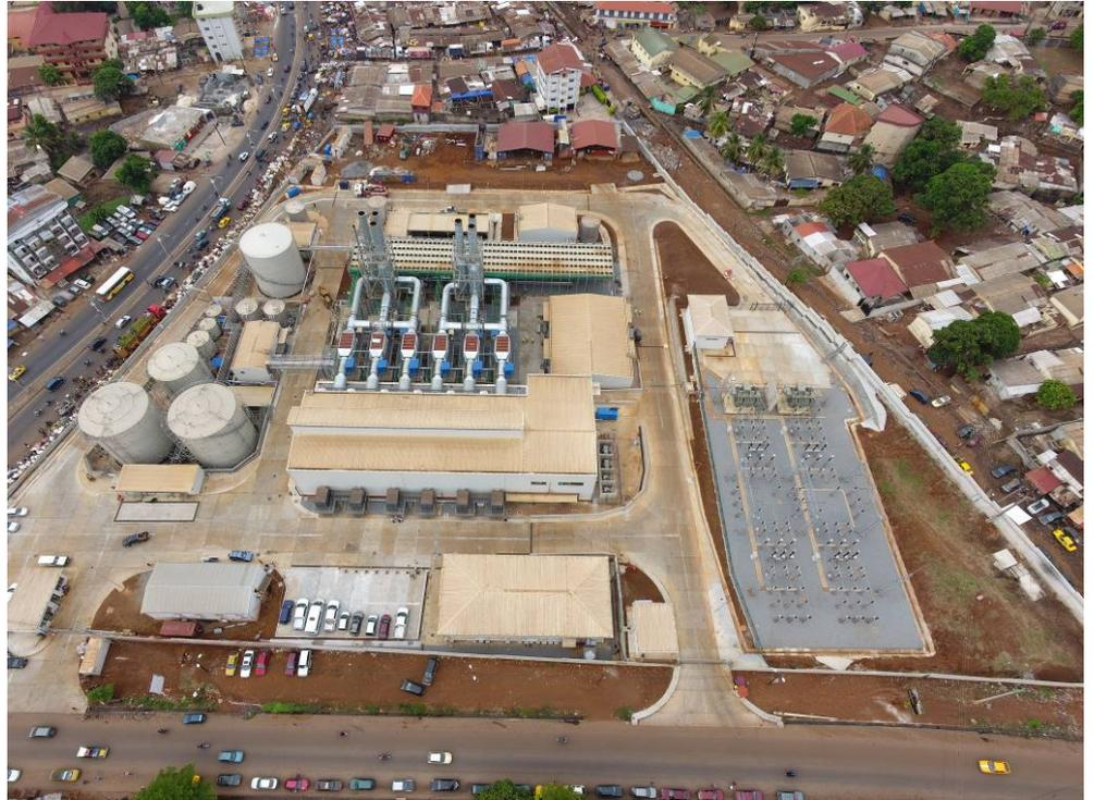
*In Conakry, Guinea, hat MAN Energy Solutions sechs MAN 18V32/40-Motoren in einem Kraftwerk installiert, das von nun an 53 MW elektrische Leistung bereitstellen wird.*
