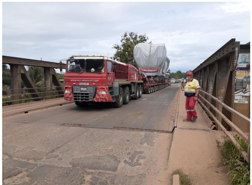
*Motorentransport eines MAN 18V51/60TS für eine Kraftwerkserweiterung in Kossodo, Burkina Faso.*
