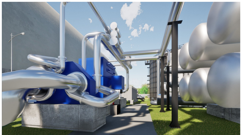
Visualisierung der CO 2 Batterie von Energy Dome
