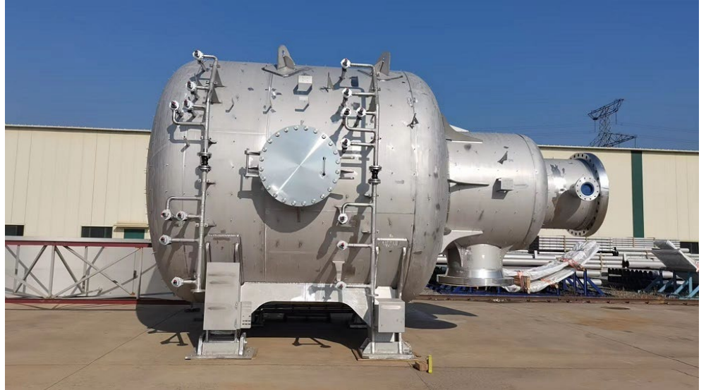
Der Cluster 5 Double Layer hat einen Durchmesser von 3.900 mm und ein Gesamtgewicht von 28 Tonnen.
