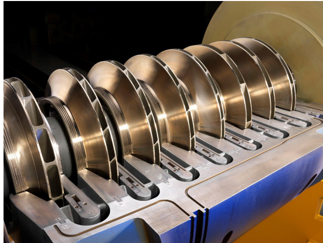
Innengehäuse und Rotor des Radialbarrel-Kompressors von MAN Energy Solutions
