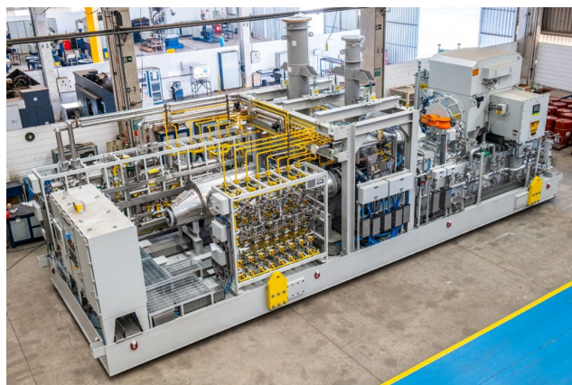
Schraubenkompressorstrang als Low Pressure (LP) Kompressionseinheit von MAN Energy Solutions
