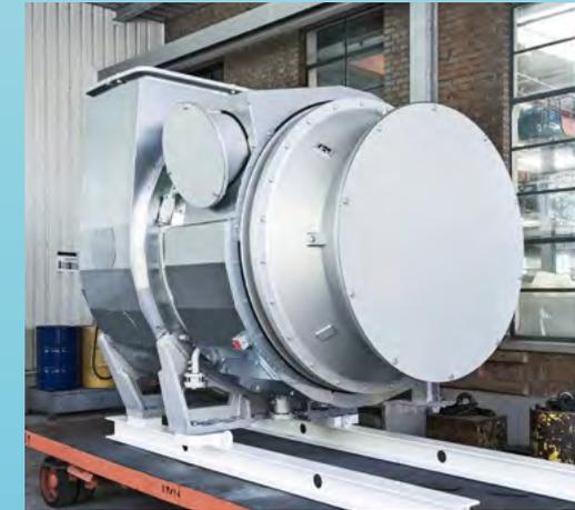
Für entsprechende Tests mit dem neuen Turbolader und einem 32/40CD wurde erstmals ein solcher Motor von einem Lizenznehmer ausgeliehen und in die EU importiert. Sodann wurde der Motor an unserem Standort in Augsburg auf einem Motorenprüfstand zusammen mit einem Prototypen des TCF-Turboladers verschiedenen umfangreichen Tests unterzogen, in denen die hohen Kraftstoffeinsparpotentiale bestätigt wurden.
